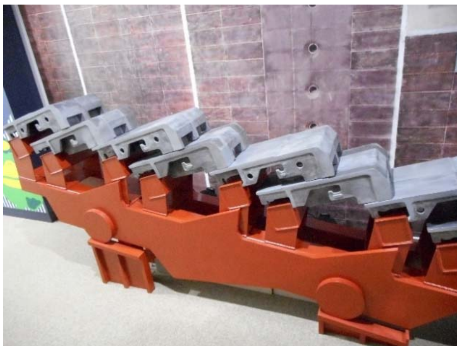
火格子の模型展示 【撮影場所】 宮ノ陣クリーンセンター
